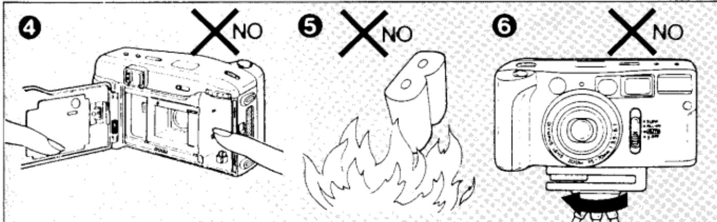
[S] ④ No toque los contactos DX. ⑤ No tire las pilas gastadas al fuego ni las caliente, desarme ni cortocircuite. ⑥ No apriete excesivamente el tornillo del trípode.
