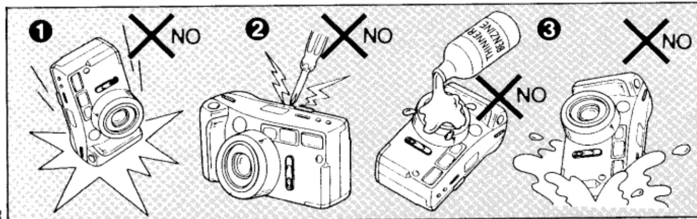
[G] ❶ Die Kamera nicht auf eine harte Fläche fallen lassen. ❷ Die Kamera nicht selbst auseinanderbauen. ❸ Die Kamera nicht mit Verdünnungsmitteln, Benzin oder organischen Substanzen reinigen. Die Kamera nicht naß werden lassen und nicht in Wasser fallen lassen.
